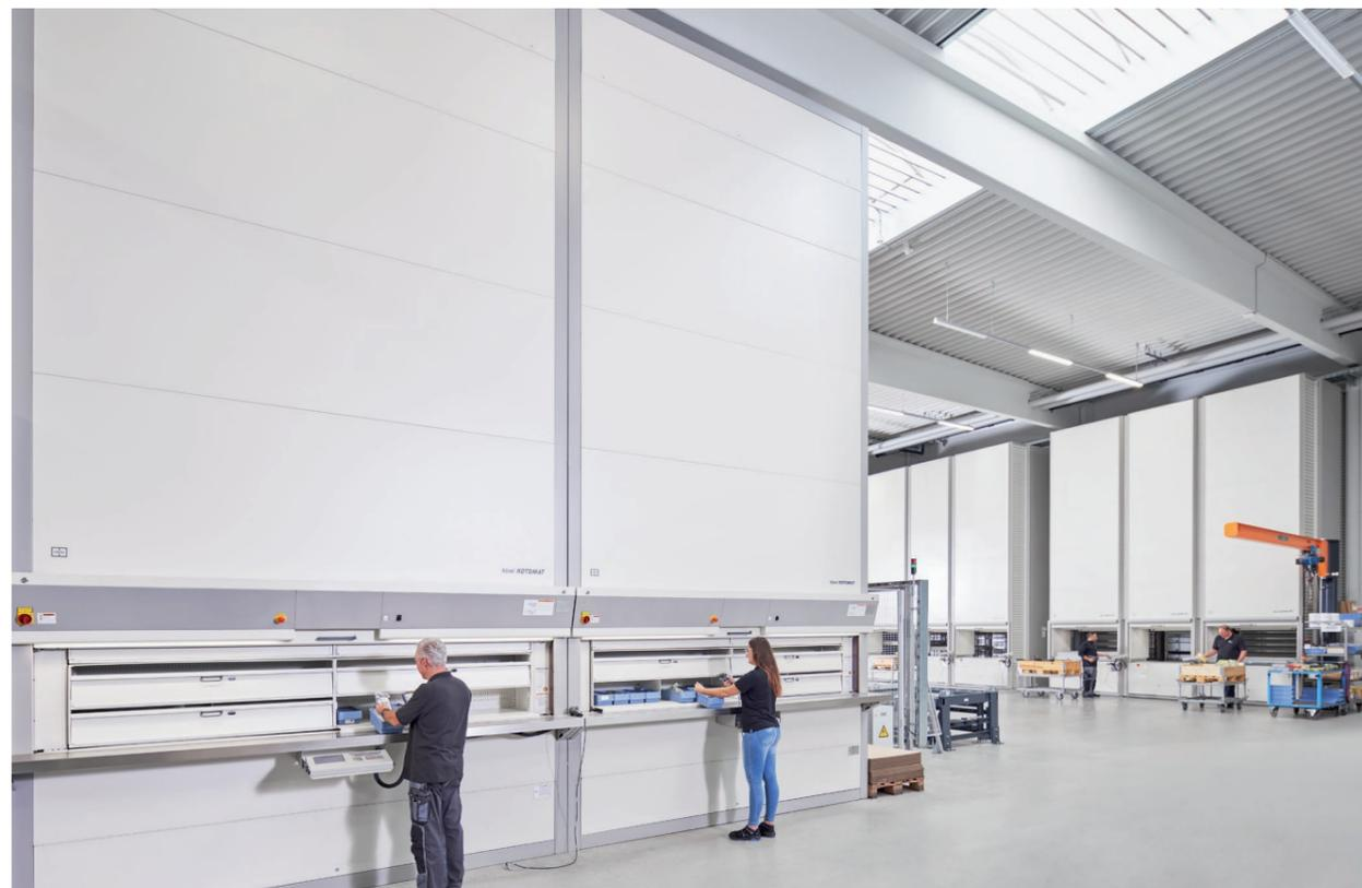
Für eine effiziente Abwicklung aller Aufträge bei optimaler Raumnutzung kommen im zentralen Lager sowohl Hänel Vertikallifte als auch Hänel Umlaufregale zum Einsatz
