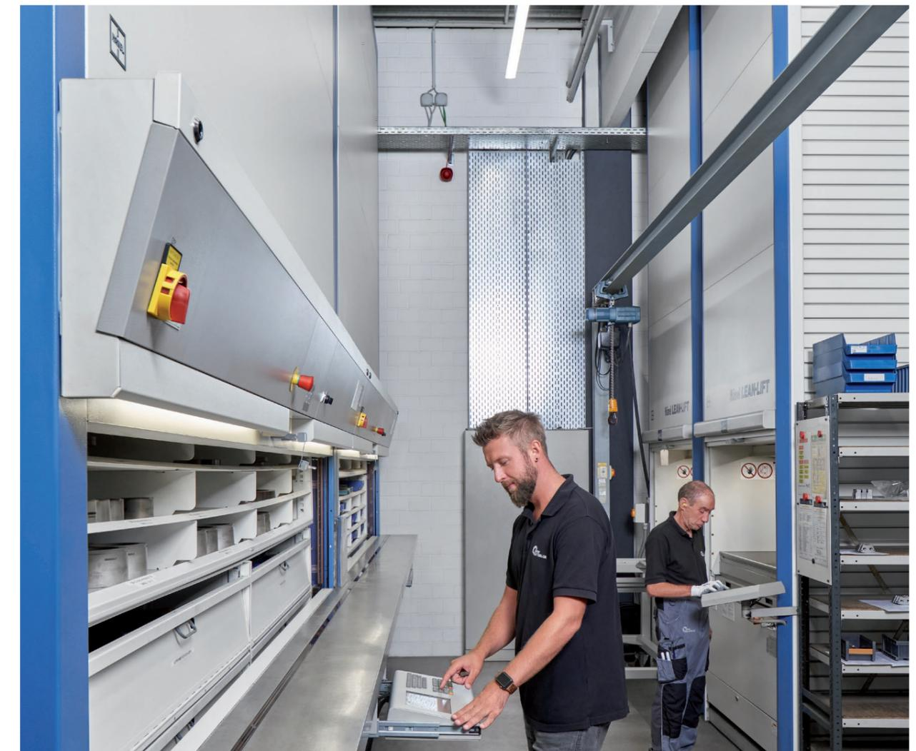
Im Ersatzteillager des Maschinenparks der Sonderfertigung kommen zwei weitere Hänel Rotomat® Lagerlifte und zwei Hänel Lean-Lifte® zum Einsatz
