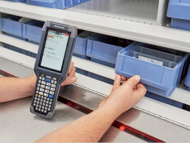
Für den schnellen und sicheren Zugriff werden die Lagerplätze am Hänel Rotomat® Lagerlift per Fachanzeige markiert
