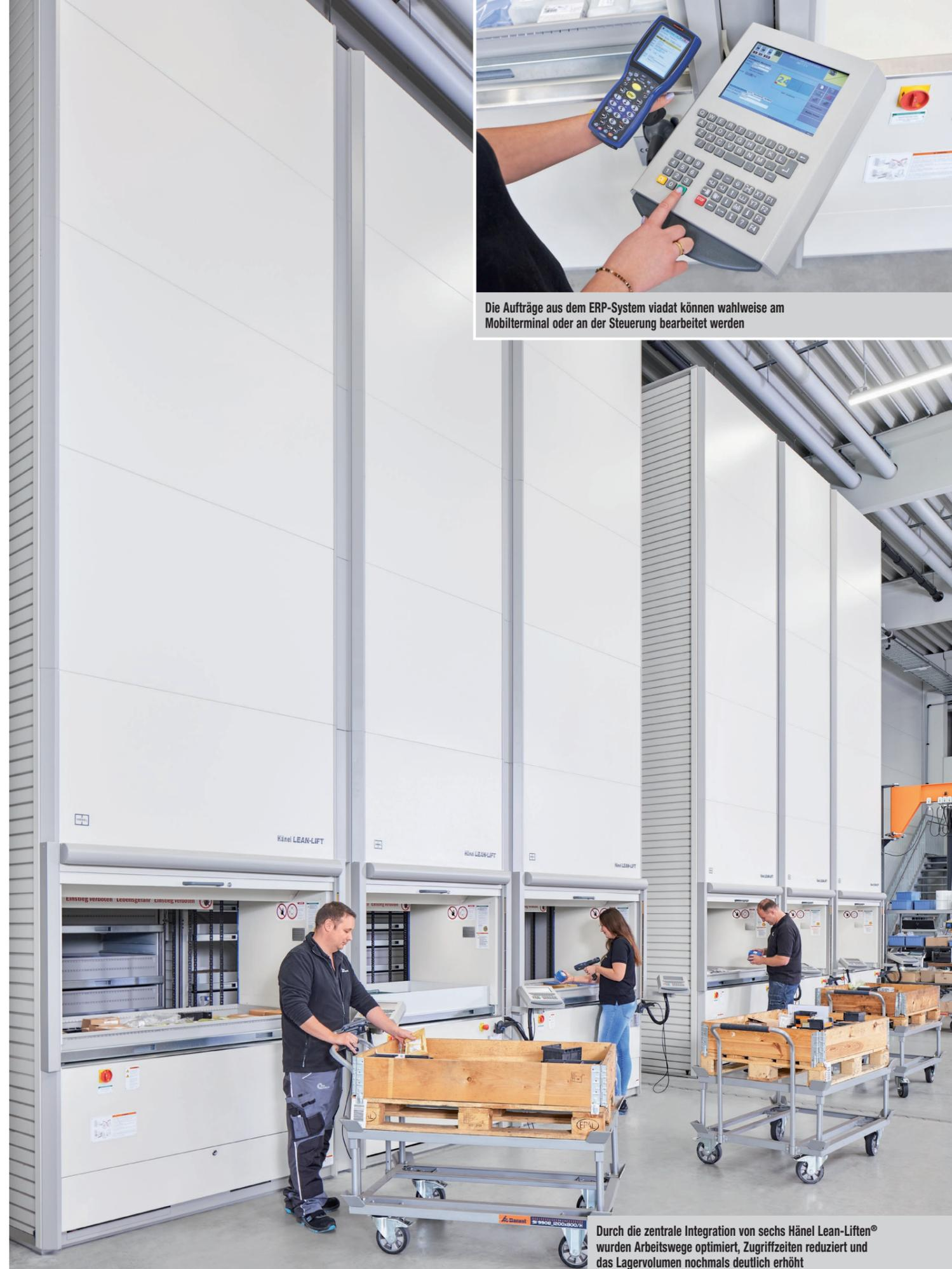
Durch die zentrale Integration von sechs Hänel Lean-Liften® wurden Arbeitswege optimiert, Zugriffszeiten reduziert und das Lagervolumen nochmals deutlich erhöht
