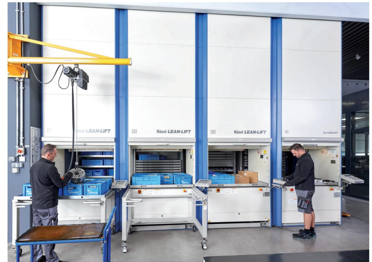
Für einen ergonomischen und sicheren Zugriff auf die schweren Spannfutter können die Hänel Multifunktions-Container aus dem Lean-Lift® auf den Transportwagen herausgezogen und das Lagergut dann per Schwenkkrane verladen werden
