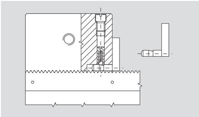
Das langzeiterprobte CLAK-System ermöglicht den Schnellwechsel von Parallelleisten und Backen auf den Mehrfachspannsystemen CV bei höchster Wiederholgenauigkeit. Dadurch werden Rüstzeiten drastisch reduziert.
