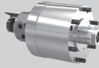
Cilindro hidráulico sin paso de barra, con válvulas de seguridad incorporadas y control de carrera. Paso de barra central para aire y / o refrigerante (p<sub>max.</sub> = 70 bar)
