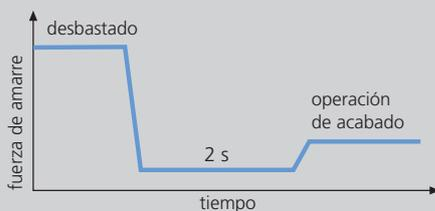
La combinación entre un plato KNCS-NB / KNCS-NBX con accionamiento por cremallera y el cilindro SMW-AUTOBLOK SIN-HL compatible con el ciclo "variable" permite una reducción controlada de la fuerza de amarre.
