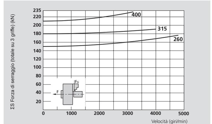
I dati nel diagramma si riferiscono ad autocentranti a 3 griffe, in buone condizioni di usura e pulizia e ingrassati con grasso SMW-AUTOBLOK K67 come prescritto nel manuale d'uso. Le forze di serraggio statiche e dinamiche sono state misurate utilizzando una serie di morsetti di dotazione, non fuoriuscenti dal diametro dell'autocentrante.
