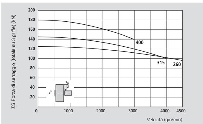
I dati nei diagrammi si riferiscono ad autocentranti a 3 griffe, in buone condizioni di usura e pulizia e ingrassati con grasso SMW-AUTOBLOK K67 come prescritto nel manuale d'uso. Le forze di serraggio statiche e dinamiche sono state misurate utilizzando una serie di morsetti di dotazione, non fuoriuscenti dal diametro dell'autocentrante.
