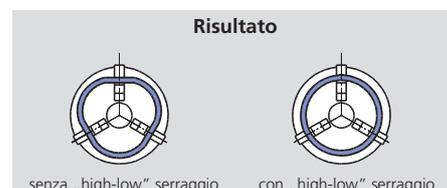
Per i pezzi deformabili SMW-AUTOBLOK propone il sistema di serraggio "High-Low". La grande forza di serraggio per l'operazione di sgrossatura è ridotta per l'operazione di finitura, senza aprire l'autocentrante.
