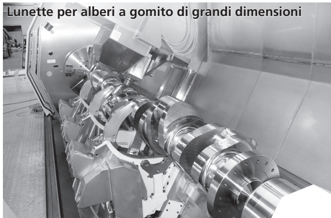
Lunetta per supporto di alberi turbina
