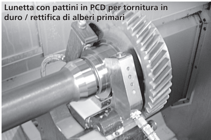
Lunetta per supporto di albero settore aeronautico
