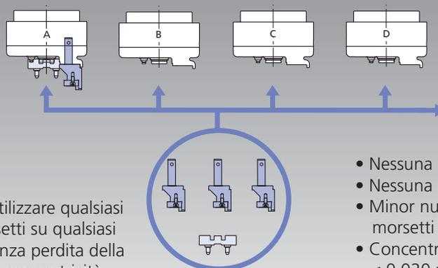
È possibile utilizzare qualsiasi serie di morsetti su qualsiasi mandrino senza perdita della precisione di concentricità.
