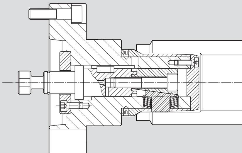
**Esempio: Espansibile speciale con pinza a doppio cono ed appoggio retrattile per statori di motori elettrici**
