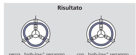
Per i pezzi deformabili SMW-AUTOBLOK propone il sistema di serraggio "High-Low". La grande forza di serraggio per l'operazione di sgrossatura è ridotta per l'operazione di finitura, senza aprire l'autocentrante.
