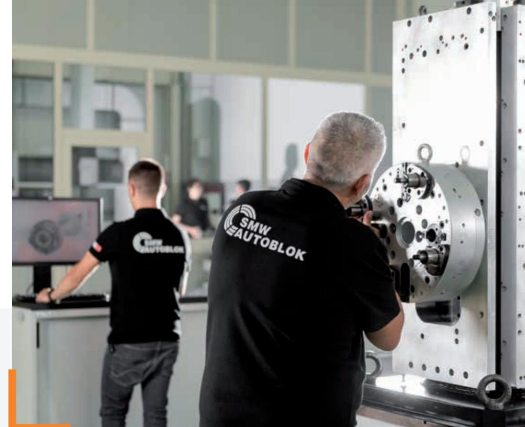
L'area di montaggio è attrezzata con pc e monitor collegate direttamente con l'ufficio tecnico, in modo da poter visualizzare i progetti in 3D, facilitare il montaggio e ridurre i tempi di assemblaggio.
