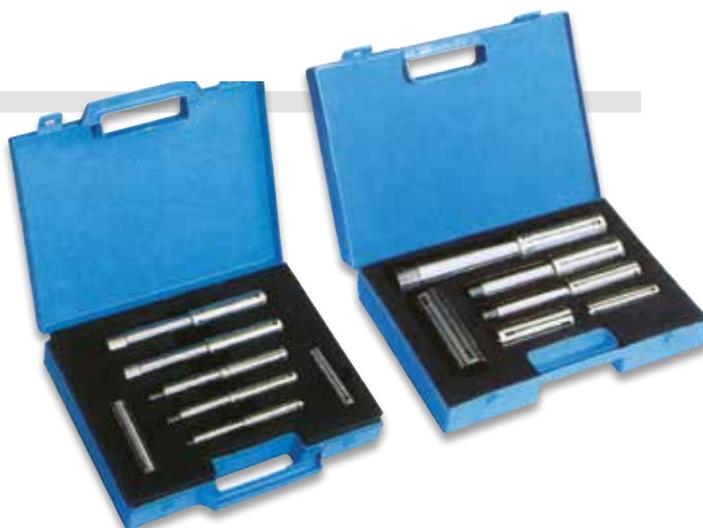
Il est admis que chaque poste de travail où se déroulent le contrôle et la rectification possède un jeu de cales étalons d'angle et autres instruments de mesure, et que les postes de travail sont également équipés de jeux de mandrins TEP.
