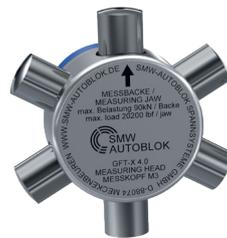
Cabezal de medición para platos de 2, 3 y 6 garras
