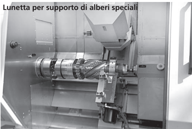
Lunetta con pattini in PCD per tornitura in duro/rettifica di alberi primari
