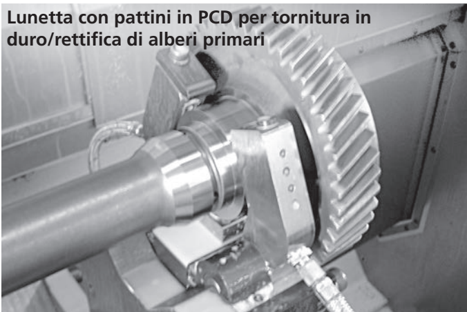
Lunetta per supporto di albero settore aeronautico
