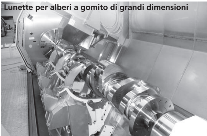
Lunetta per supporto di alberi turbina
